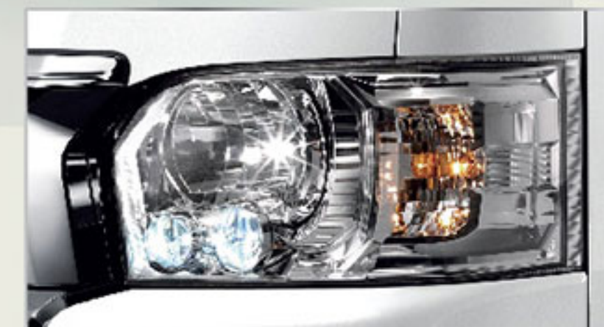
ไฟหน้า LED ใหม่ เปิด-ปิด แลปรับระดับสูง-ต่ำอัตโนมัติ
