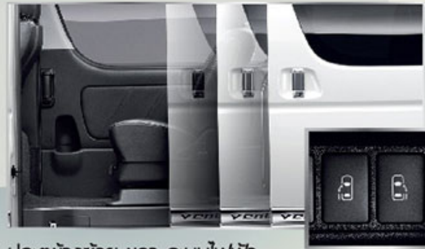
ประตูข้างซ้าย-ขวา ระบบไฟฟ้า สะดวกสบายเหมือนรถบัส สามารถสั่งเปิด-ปิดได้จากบริเวณคนขับ
