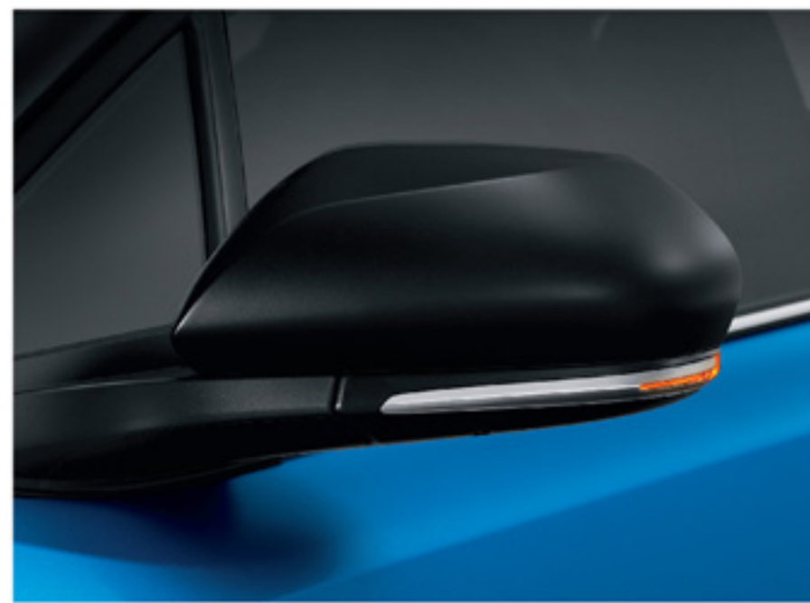
กระจกมองข้างปรับไฟฟ้า และพับเก็บอัตโนมัติ พร้อมไฟเลี้ยวแบบ LED
